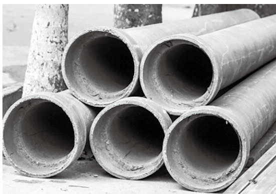
石綿セメント管
