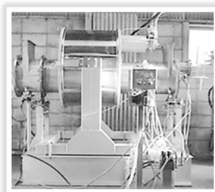
超伝導磁石を使った土壌の磁気分離試験
