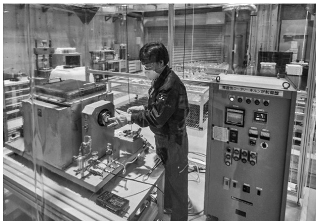
小型回転式電気炉による汚染廃棄物の減容化実験のようす
