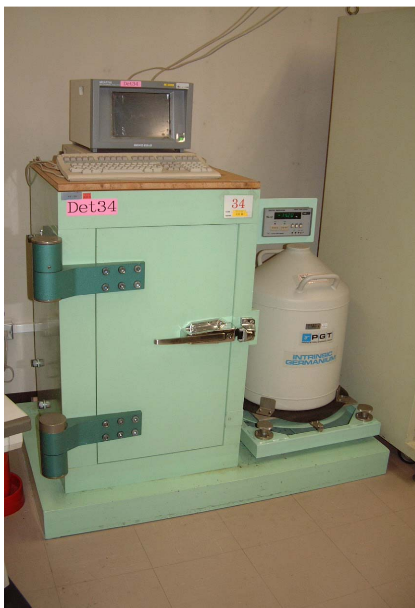
ゲルマニウム半導体検出器を 備えたガンマ線測定装置
