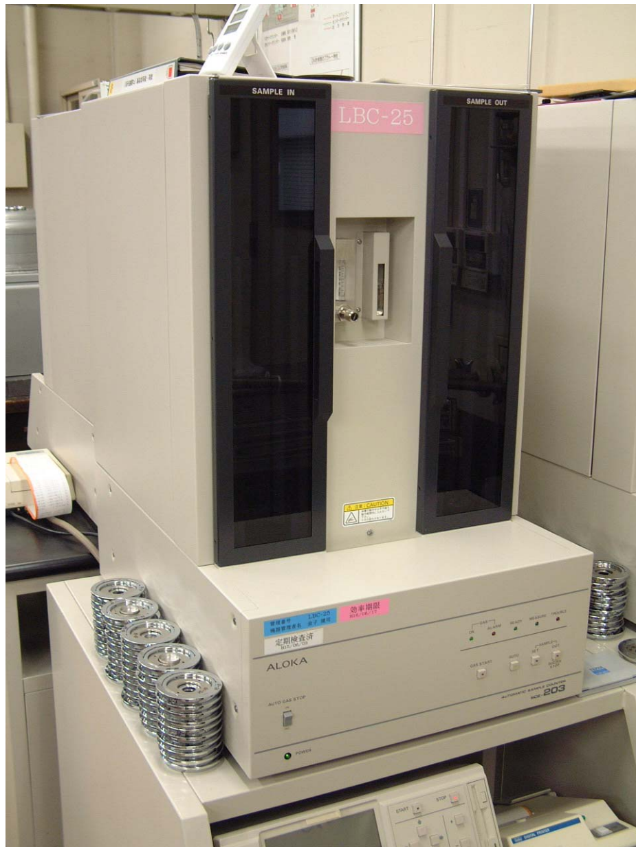
GM計数管を備えたベータ線測定装置
